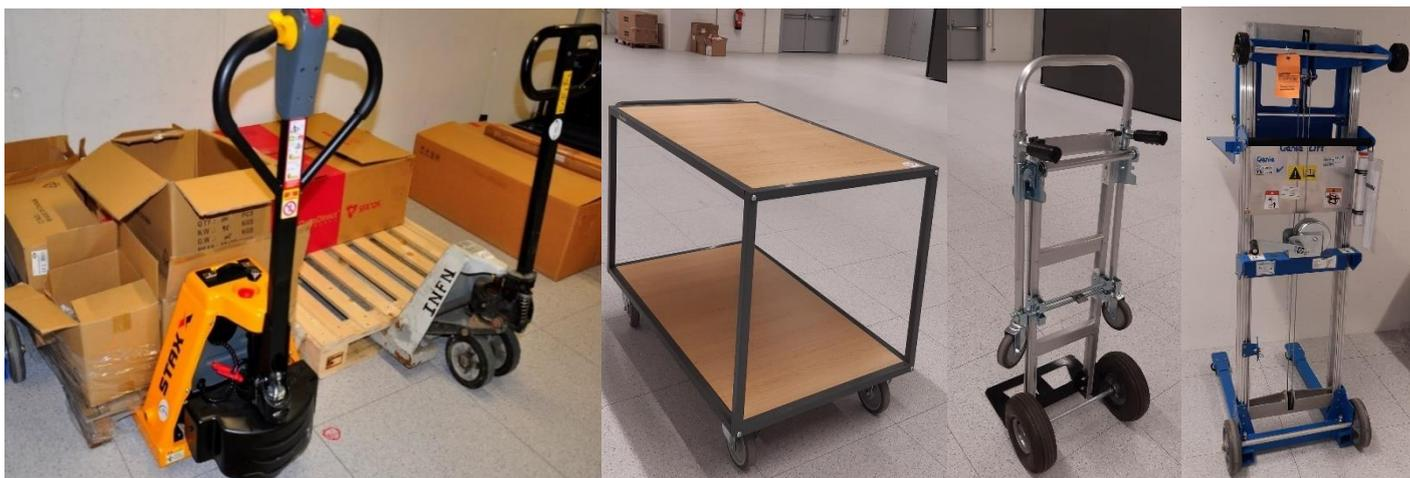
Transpallet elettrico (a sinistra) e manuale, due esempi di carrelli ed il sollevatore di carico (a destra).
